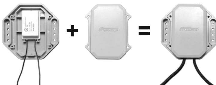
Рисунок 3. Внешний вид датчика-детектора ДД-А. Слева – модуль ДД-А установленный на основании кожуха, в центре – крышка кожуха, справа – собранный датчик.
